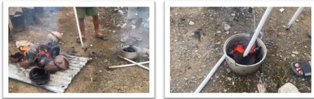
Gambar 4. Proses Pembakaran Sabut (kiri) dan Penghalusan Menjadi arang (kanan)
